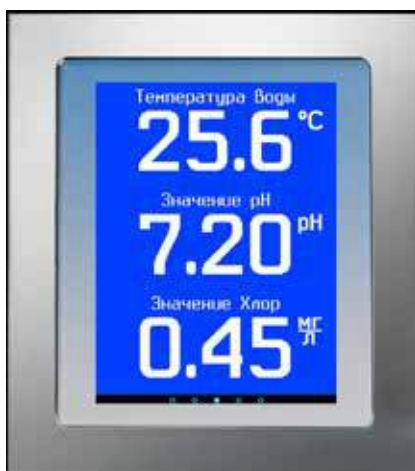
Цветной тактильный экран с хромированной рамкой для утепленного монтажа.
