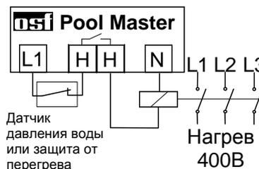
Датчик давления воды или защита от перегрева
