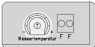
Электронная схема регулирования температуры и датчик согласованы между собой. В случае замены датчика или удлинения его кабеля, необходимо с помощью потенциометра находящегося в отсеке с клеммами провести новое согласование. Вращение потенциометра по часовой стрелке приводит к увеличению показания температуры.
