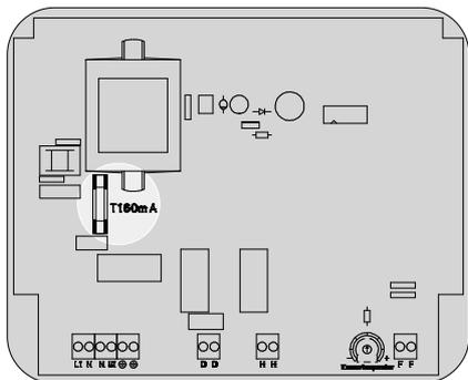
Электронная часть защищена плавким предохранителем (160mA) находящимся на монтажной плате внутри «Pool-Master 230 digital». Так как блок управления не предохраняет фильтрационный насос от короткого замыкания, то необходимо предварительно установить защитное устройство с током срабатывания не более 16А.
