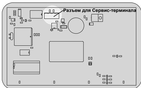
Для оптимальной адаптации блока управления к различному оборудованию, а также для облегчения ввода в эксплуатацию и последующего обслуживания можно к блоку управления подключать osf-Service-Terminal (Арт.N.3010000900). Соответствующий разъем находится на внутренней стороне монтажной платы лицевой панели.
